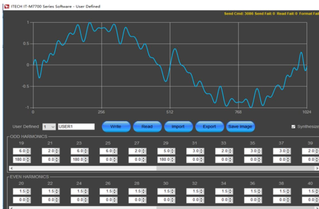
图 3 IT-M7700 谐波模拟示意图
