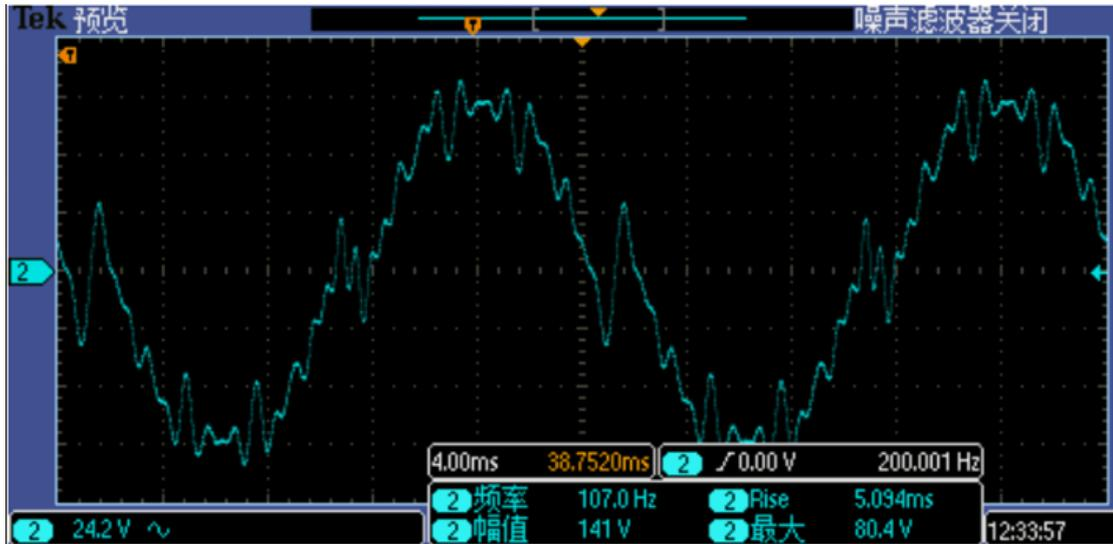
图 4 IT-M7700 谐波模拟示波器图
